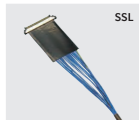
【电缆保护示例】 胶带粘贴
